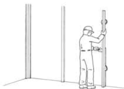
Fig. 5. Ejecución de maestras rellenando las holguras.
