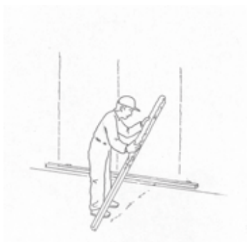
Figs. 6 y 7. Se aplica la pasta de Onegyps® YP sobre las reglas.
