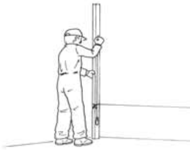
Fig. 1. Colocación de reglas
